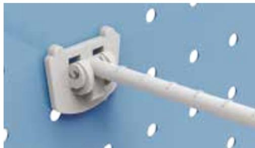
Одинарные или двойные пластиковые крючки. Устанавливаются в перфорированные панели из металла, толщиной 4-6 мм. Предназначены для перфорации с шагом в 25 мм. Стандартные варианты длины – 100, 150, 200, 250 мм. Стандартный цвет – белый, другие цвета – по запросу.
