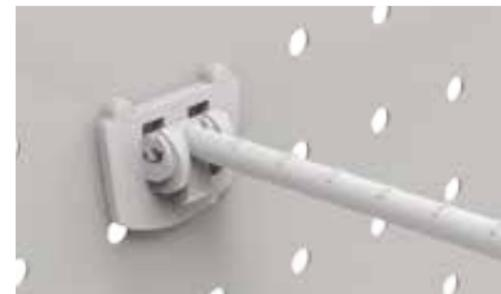
Одинарные или двойные пластиковые крючки. Устанавливаются в перфорированные панели из металла, толщиной 1,0 - 2,0 мм. Предназначены для перфорации с шагом в 25 мм. Стандартные варианты длины – 100, 150, 200, 250 мм. Стандартный цвет – белый, другие цвета – по запросу.
