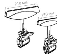
Держатель прозрачного пластикового кармана из акрила или ПЭТ толщиной 1,5 мм или плаката из картона толщиной 2-3 мм. Крепится на трубе (диаметром до 40 мм), товаре, краю полки. Рекомендуется использовать с рекламными плакатами форматов А5 или А4 (в зависимости от ширины держателя).
