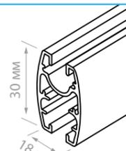
Алюминиевый профиль UNITRACK – основа подвесной системы. Используется в сочетании с пластиковой перфорированной вставкой UNI-LINE или с алюминиевой трубкой для подвешивания баннеров и плакатов из ткани. Длина 2 метра, другие длины на заказ.
