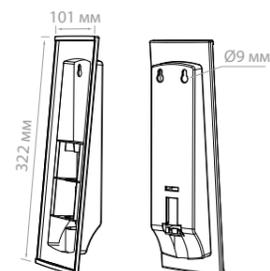
Настенная перекидная система с 10-ю рамками DATAFRAME формата A4. Настенный держатель изготовлен из высококачественного пластика, имеет два отверстия типа «замочная скважина» для крепления на стене. Форма держателя обеспечивает небольшой угол наклона рамки относительно стены. Комплектация рамками выбранного цвета.
