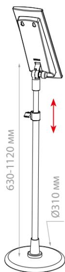
Устойчивая напольная перекидная система с 10-ю рамками DATAFRAME формата A4 и металлическим основанием. Угол наклона держателя регулируется. Комплектация рамками выбранного цвета.
