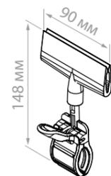
Держатель рекламного плаката из картона, заламинированной бумаги или пластика с зажимом-прищепкой для крепления на трубе (макс Ø 40 мм), товаре, краю полки (макс.толщина 35 мм).
