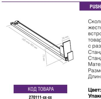
**PUSHER-FSR** Пружинный толкатель со скользящей основой
