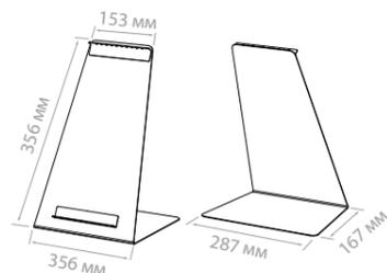
Устойчивая настольная перекидная система с 10-ю рамками INFOFRAME формата A4 и металлическим основанием. Угол наклона держателя к плоскости стола – 60°. Комплектация рамками выбранного цвета.
