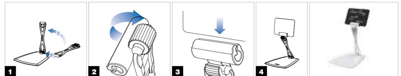
Эта комбинация позволяет регулировать высоту ценникодержателя, благодаря возможности регулировки наклона в двух точках.
