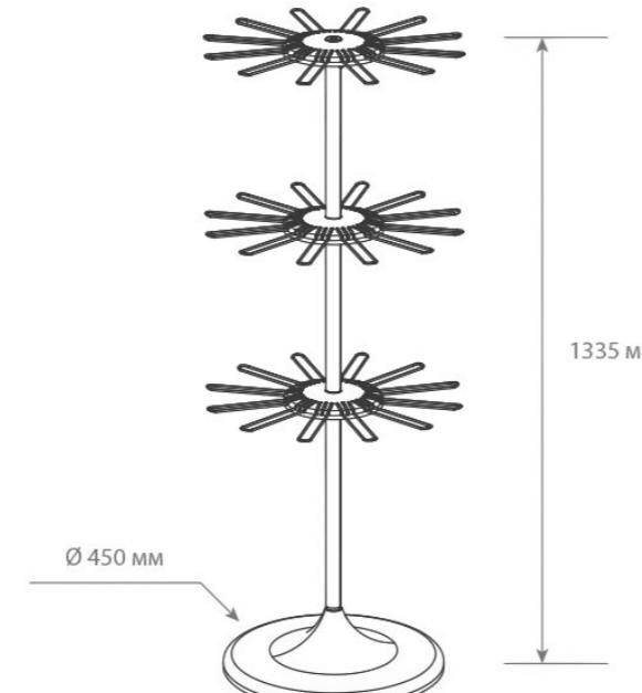
Дисплей состоит из нескольких частей, которые легко собираются между собой без использования инструмента (см. схему): пластиковое основание, труба длиной 520 мм, две трубы длиной 410 мм, три пластиковых держателя, по 12 крючков в каждый держатель, заглушка, защищающая полость трубы.
