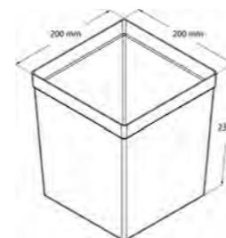
Контейнер ICEBOX - решение зонирования для холодильных бонет, позволяет сделать секции для весовых/фасованных товаров. Изготовлен из пищевого, морозостойкого и ударопрочного пластика (поликарбонат). За счет универсального размера удачно компонуется в большинство холодильников. Может использоваться и вне холодильников. Габариты: 200×200×230 мм.
