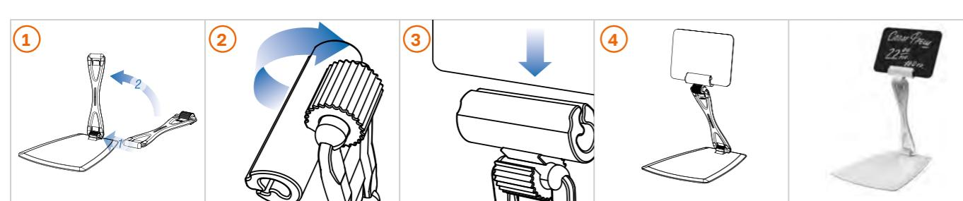
Эта комбинация позволяет регулировать высоту ценникодержателя, благодаря возможности регулировки наклона в двух точках
