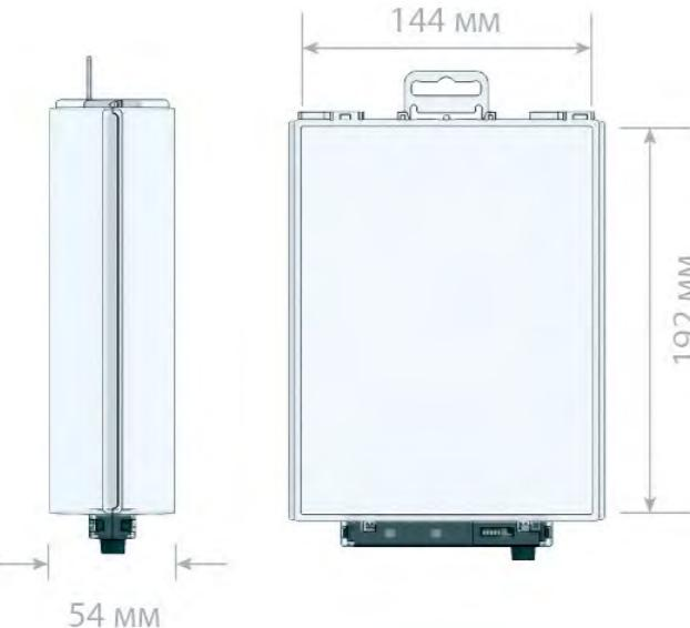
Изготовлены из ударопрочного пластика. В замок интегрировано два типа противокражных датчиков РЧ и АМ. Два способа размещения защитного бокса – подвешивание на крючке и установка на полку. Возможность изготовления с отверстием для подвешивания в корпусе бокса.
