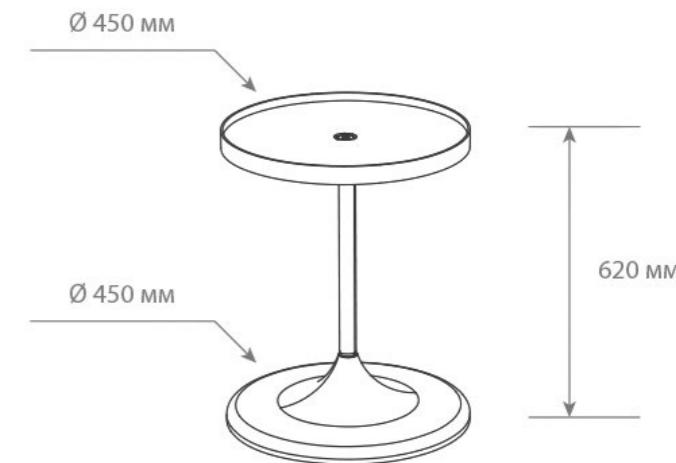
Состоит из нескольких частей, которые легко собираются между собой без использования инструмента (см. схему): пластиковое основание, труба длиной 520 мм, пластиковая полка, заглушка, защищающая полость трубы.
